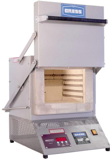
El modelo C100-6/B tiene un controlador digital programable con temporizador incluido que hará su trabajo mucho más fácil. Programe fácilmente el controlador 3K y usted estará trabajando con su horno en muy pocos minutos. Este controlador tiene la capacidad de tener hasta 4 archivos en la memoria, con 8 segmentos programables cada uno.
